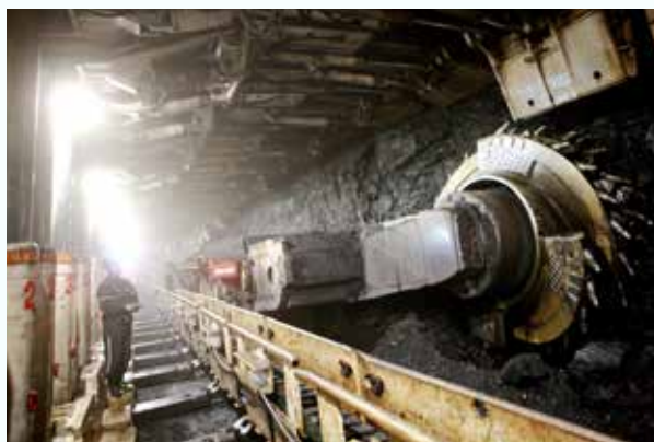
正在开采的 8101 小煤柱工作面
