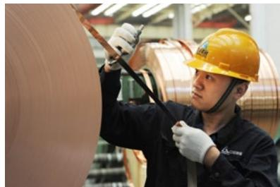
洛阳铜加工公司产品规格检验
