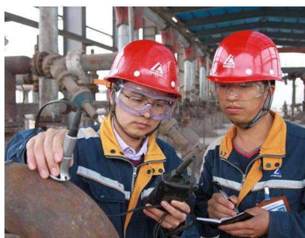
遵义氧化铝发动基层员工在进行管道测厚检查
