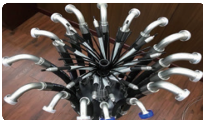
广西中源机械有限公司广泛应用软管不剥胶工艺
