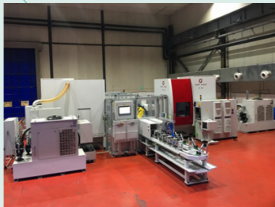
振华重工与同济大学携手打造的港口机械专用齿轴精加工智能生产线。
