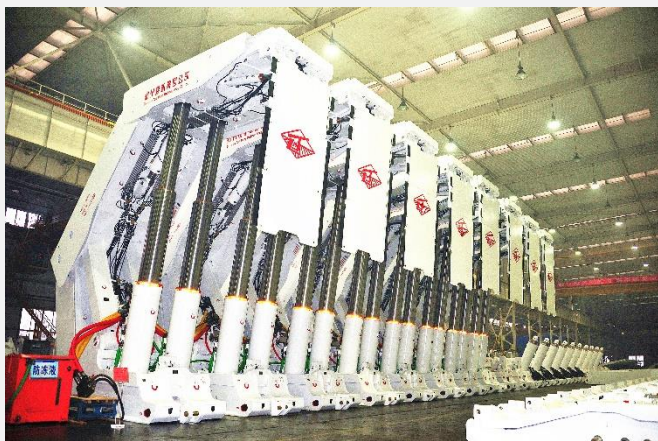
郑煤机自主研发制造的 8.8m 液压支架
