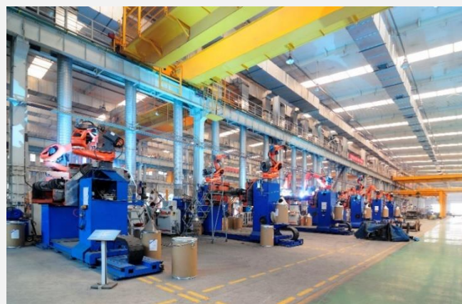
我们使用焊接机器人替代原有的手工焊机
