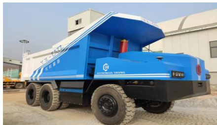
雄安项目启用“无人双向矿卡车”
