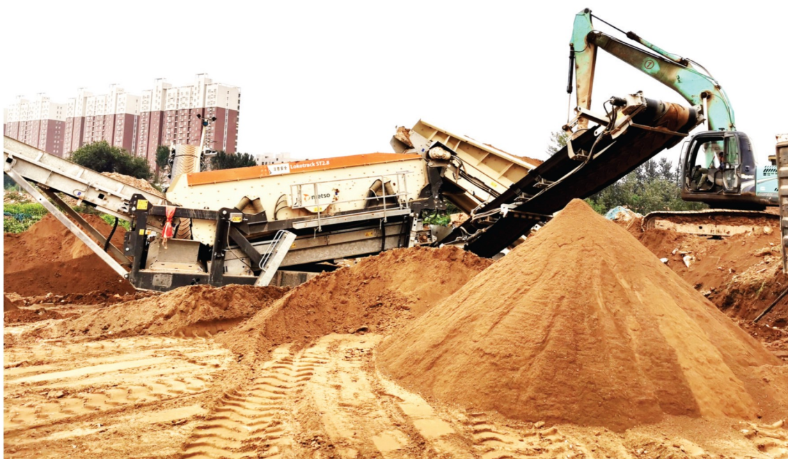
柳工ST2.8履带式筛分站正在建筑垃圾工地中作业
