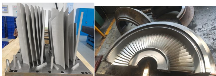
3D 打印完成后的空心静叶及装焊完成后的空心静叶
