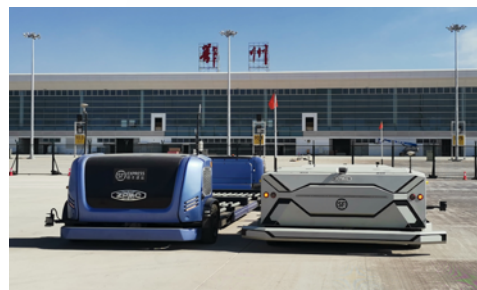
振华重工研制的两代 ULD AGV 小车
