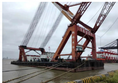
“振浮 4”防台系泊措施到位
