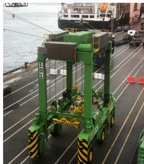
振华重工自主研发的 LNG-Hybrid 跨运车
