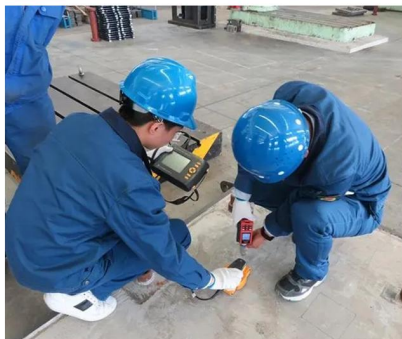
检测混凝土强度
